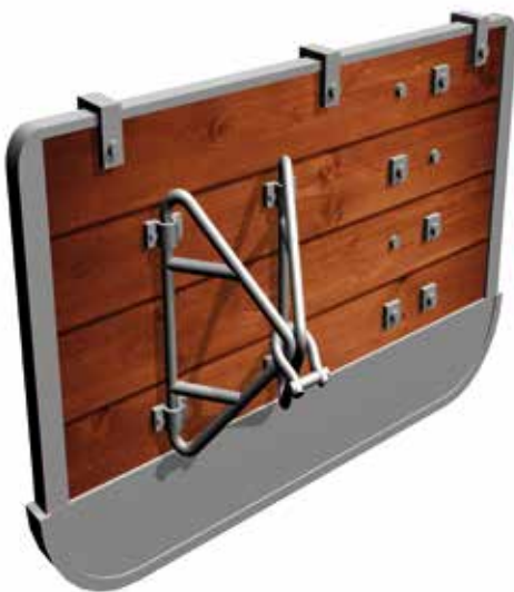
Fig 3.2 Wood trawl door
